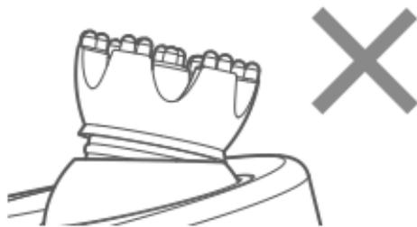
※アタッチメントは确实奥まで差し込んで取り付けてください。正しく取り付けしていないと、使用中にはずれる場合があります。
