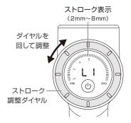
例)ストローク表示が「2、3、4、5」のとき、 ストロークは5mmに設定されています。
