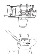
5 マイナスドライバーで本体底面のカバーシールをはがし、プラスドライバーでねじ(2つ)を取りはずす。
